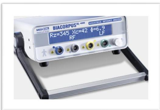
Mit vier separate Kabeleingänge wird das automatische Messen von Ganzkörper, Rumpf, Armen und Beinen innerhalb von ca. 25 Sekunden ermöglicht.
